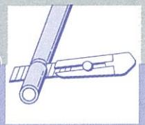
(1) 補修箇所周辺の汚れや水気を拭き、サンドペーパー等で表面を粗らします。激しい腐食は、パイプ本体を破損しない程度にヤスリで削り落しておきます。
